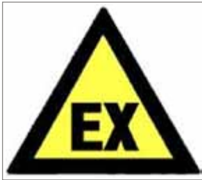
Figura A3-1 Símbolo para indicar las áreas ATEX en un lugar de trabajo
