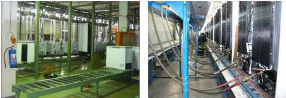
Figura 15: Línea de evacuación en sitio
