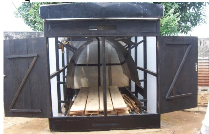
Séchoir en énergie solaire pour le bois
