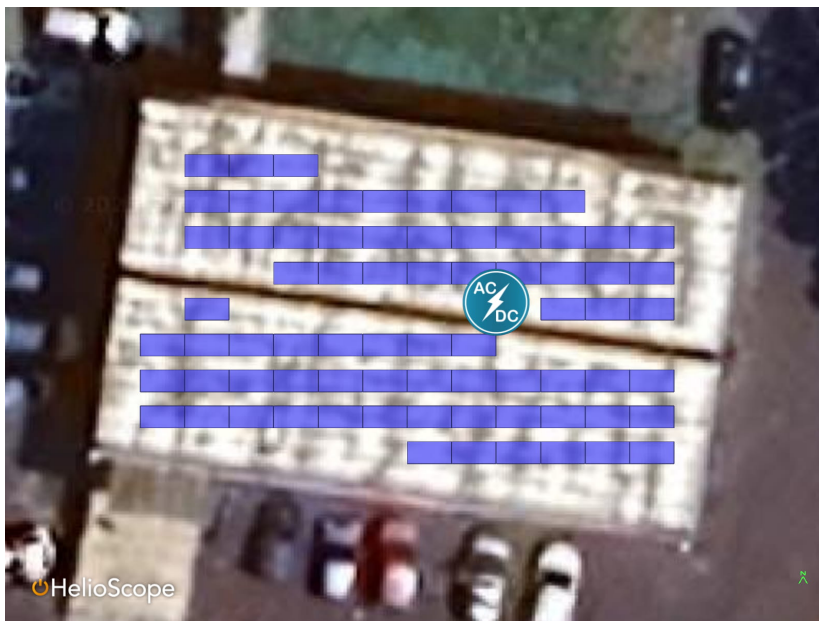
Figure 21– Illustration du principe d'implantation de modules photovoltaïques sur toiture – exemple du Tribunal de première instance de Moroni
