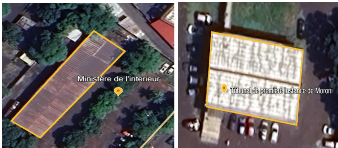
Figure 10 — Exemple de délimitation des surfaces de toitures pour l'estimation des surfaces exploitables : ministère de l'Intérieur et Tribunal de première instance de Moroni.
