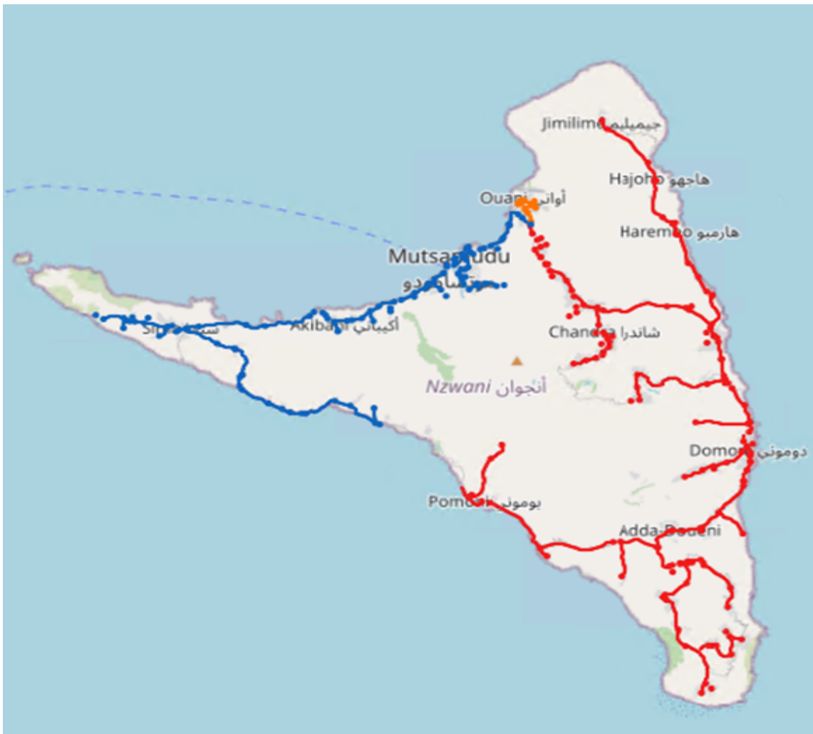
Figure 45- Architecture du réseaux 20KV à Anjouan
