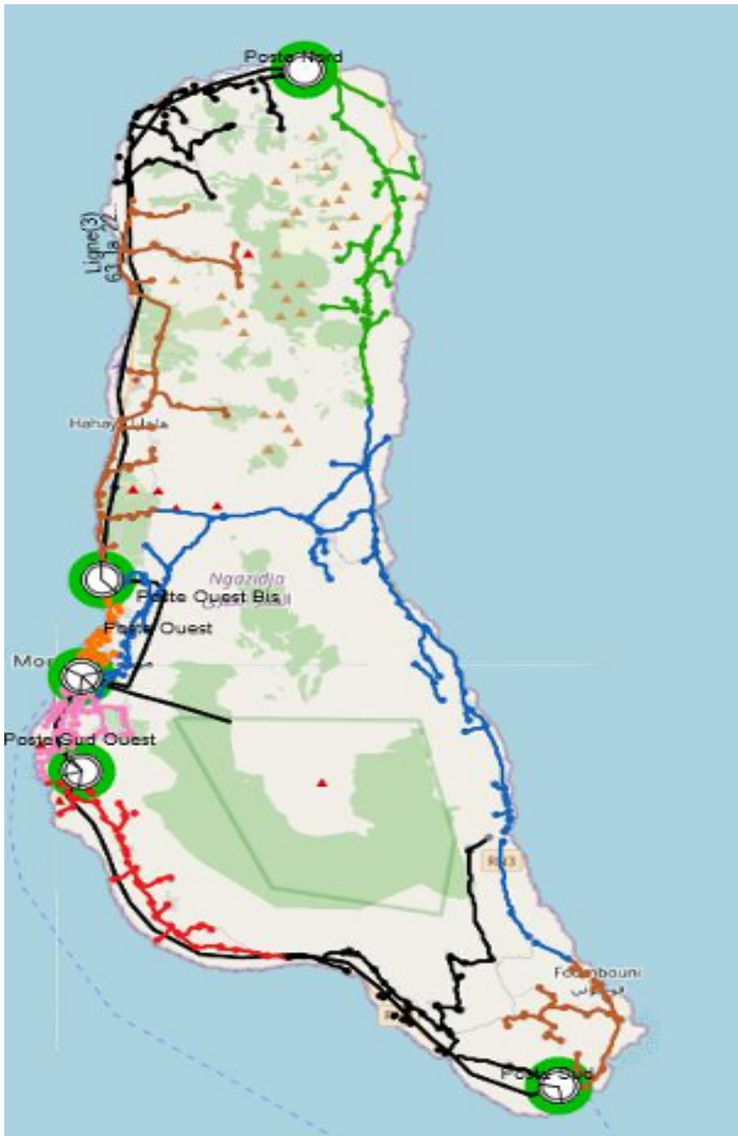
Figure 49- Topologie du réseau de 2030 Grande Comore - avec un réseau de transport 63 kV (en noir)
