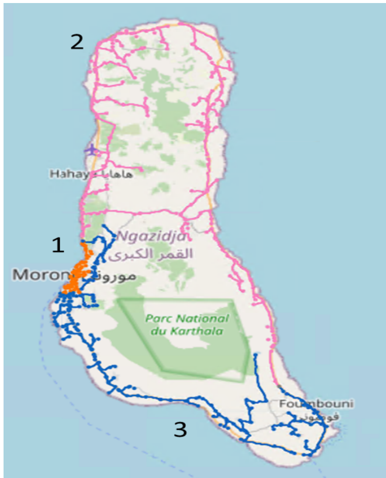
Figure 42- Architecture du réseau électrique existant de la Grande Comore : (©PAESC)
