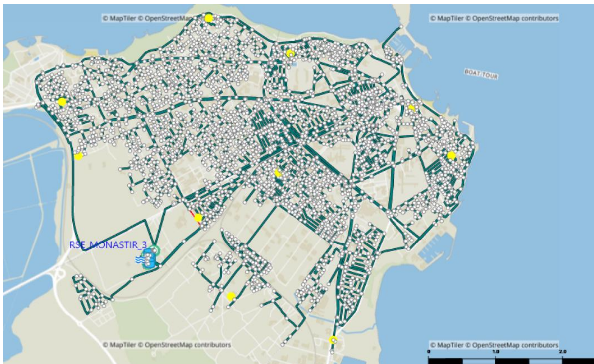
Figure 2-9: La répartition des points de mesure de pression (en jaune) sur le réseau de Monastir
