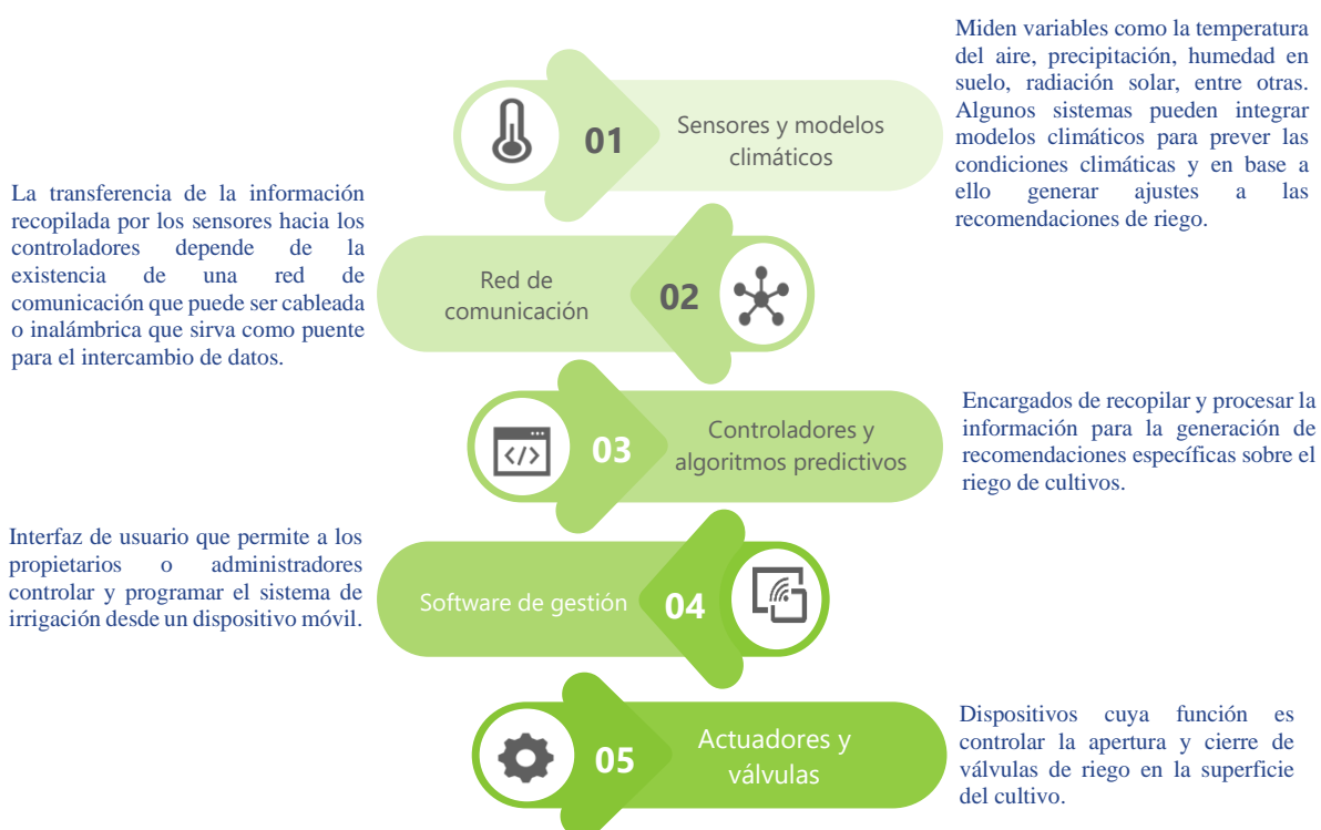
Figura 2. Componentes de un sistema de irrigación inteligente
