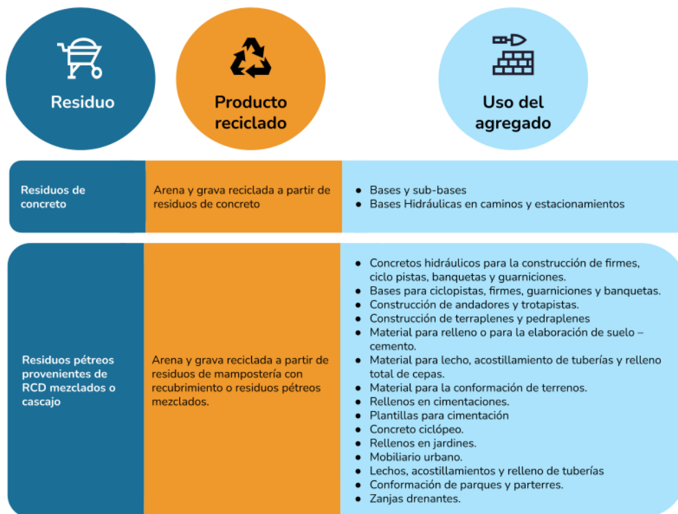
Figura 33. Usos potenciales de los agregados reciclados según su origen
