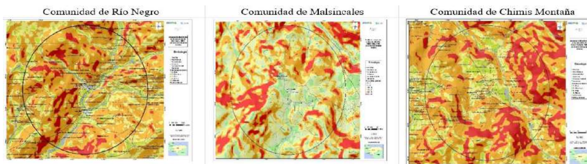
Figura 3: Amenaza potencial de deslizamientos (rojo y anaranjado) en las comunidades priorizadas
