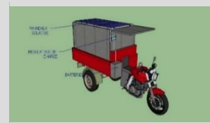
Tricycle solaire réfrigéré, permettant de collecter, transporter et conserver du lait à la température appropriée. Le dispositif de réfrigération peut être adapté localement
