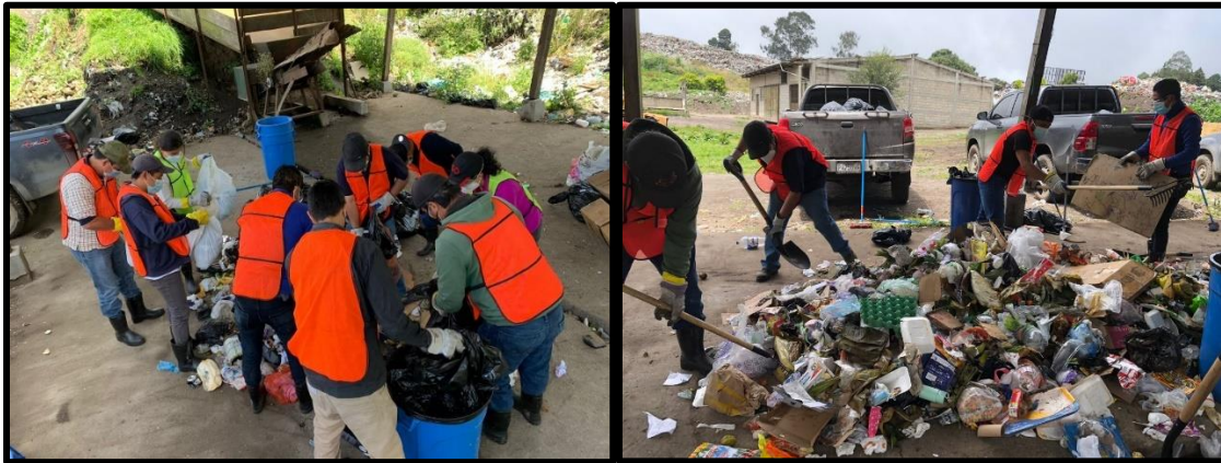
Imagen 2. Proceso de cuarteo, en la bodega proporcionada en el basurero municipal de Quetzaltenango
