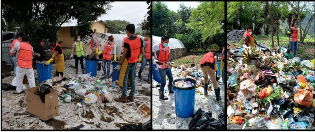
Imagen 3. Proceso de cuarteo en la bodega de BIOREM Norte para obtener la muestra a caracterizar.
