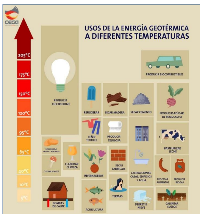
Figura 1 Usos de la energía geotérmica según la temperatura
