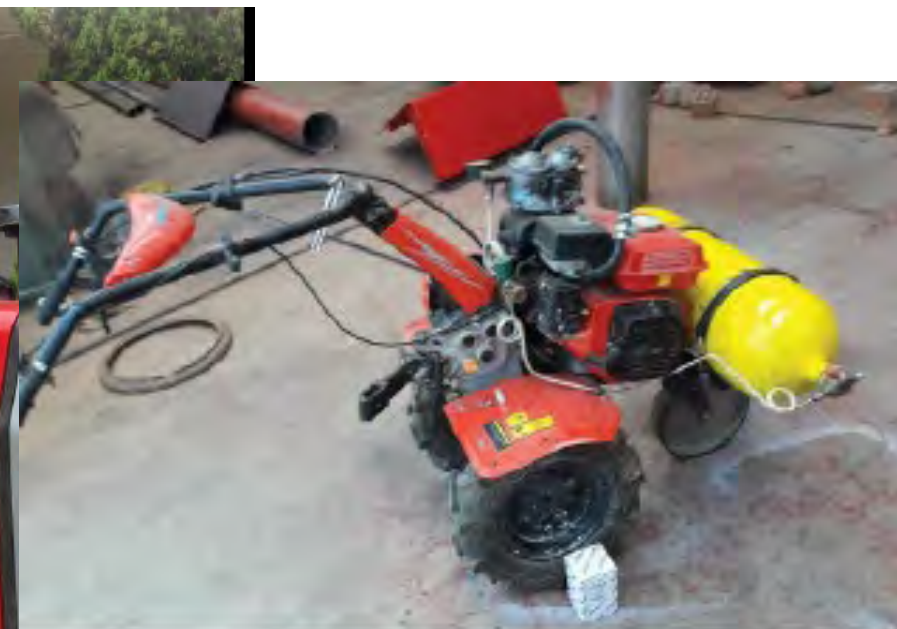
Figura 1. Tractor de 2 ruedas con motor de gasolina, adaptado para funcionar con biometano.
