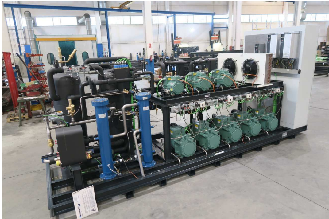
Foto 1: Central Booster Transcrítico para CO 2
