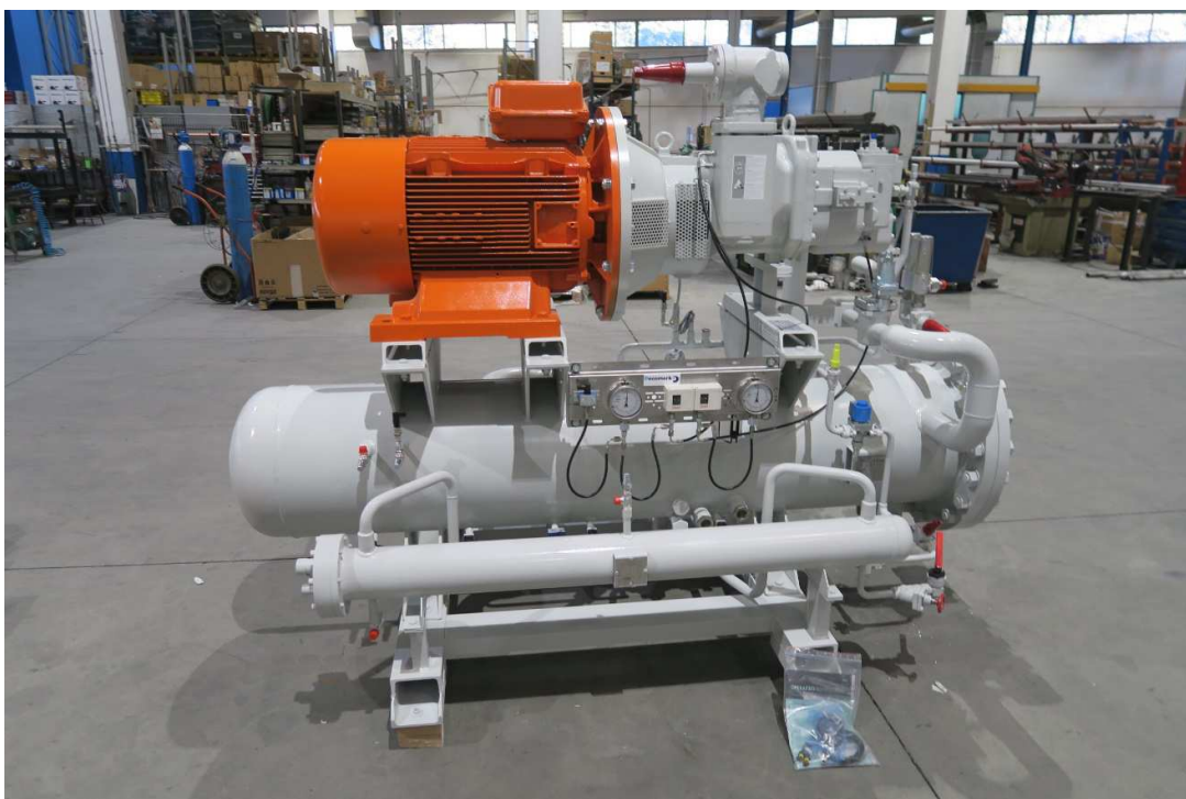
Foto 2: Unidad de compresión para NH 3 con compresor de tornillo.
