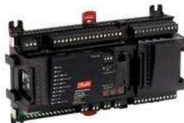
Foto 4: Controlador Danfoss AK-PC-781.
