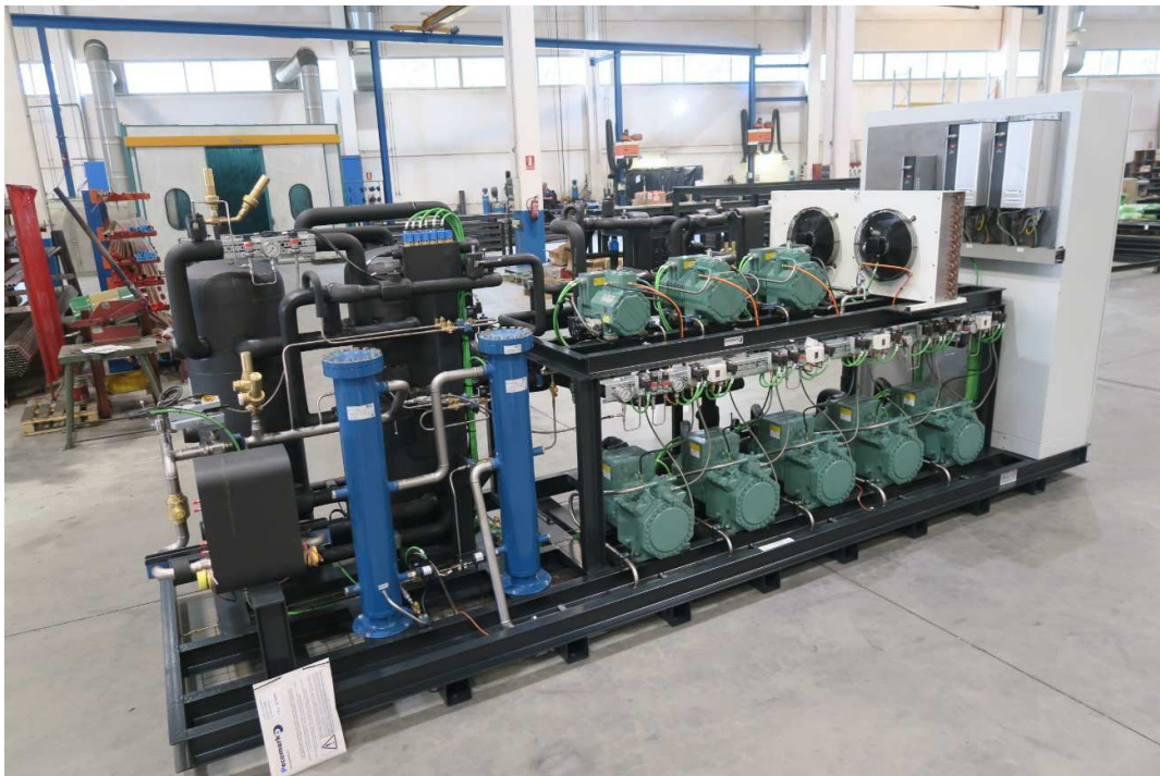
Foto 1: Central Booster Transcrítico para CO 2
