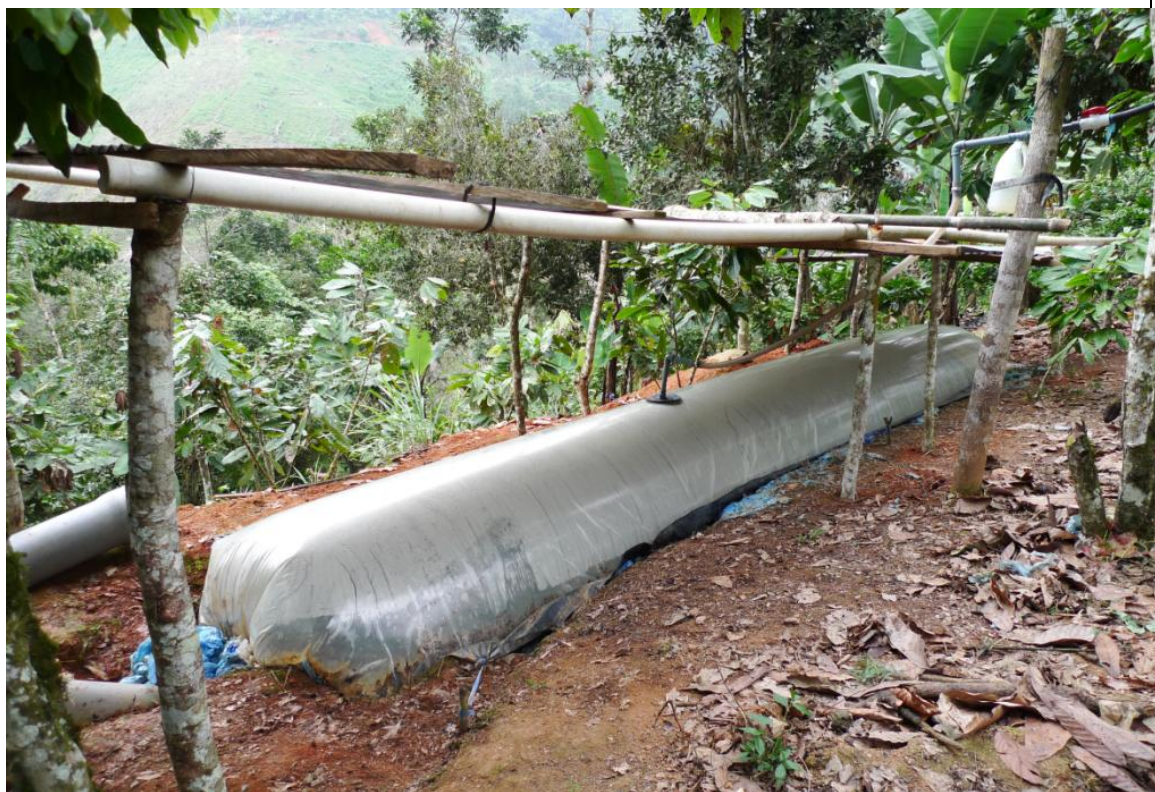
Figura 12: Biodigestor modelo Botero&Preston funcionando por 3 años en Las Lajas en 2013 (El Oro).
