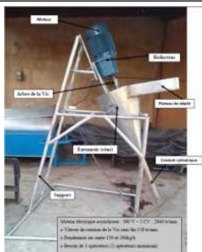
Figure 2423-: Presse à vis motorisée pour briquette de tourteau de karité
