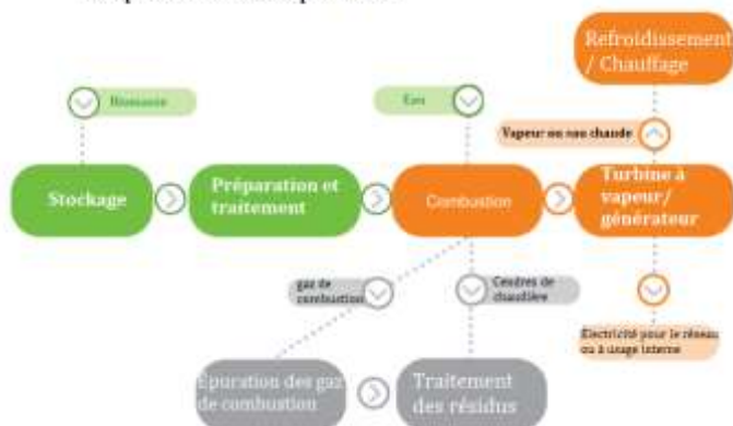
Figure 77: Schéma fonctionnel de la production d'électricité et de la récupération de chaleur par la cogénération Source : (E4Tech, 2009)
