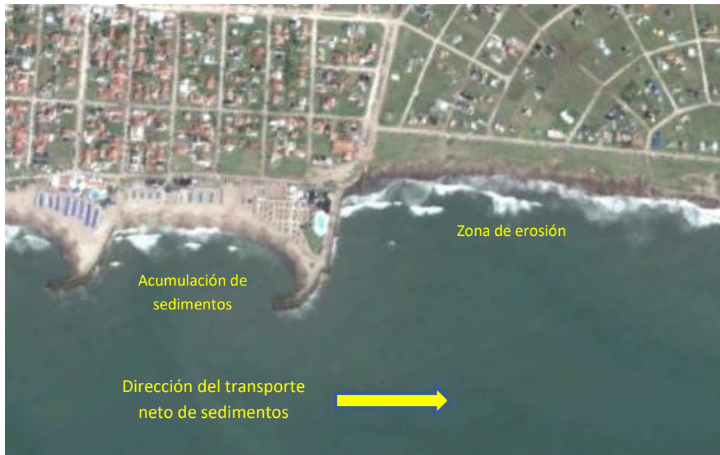
Figura 3.2. Alteración de la línea de costa en la zona de Santa Clara del Mar.
