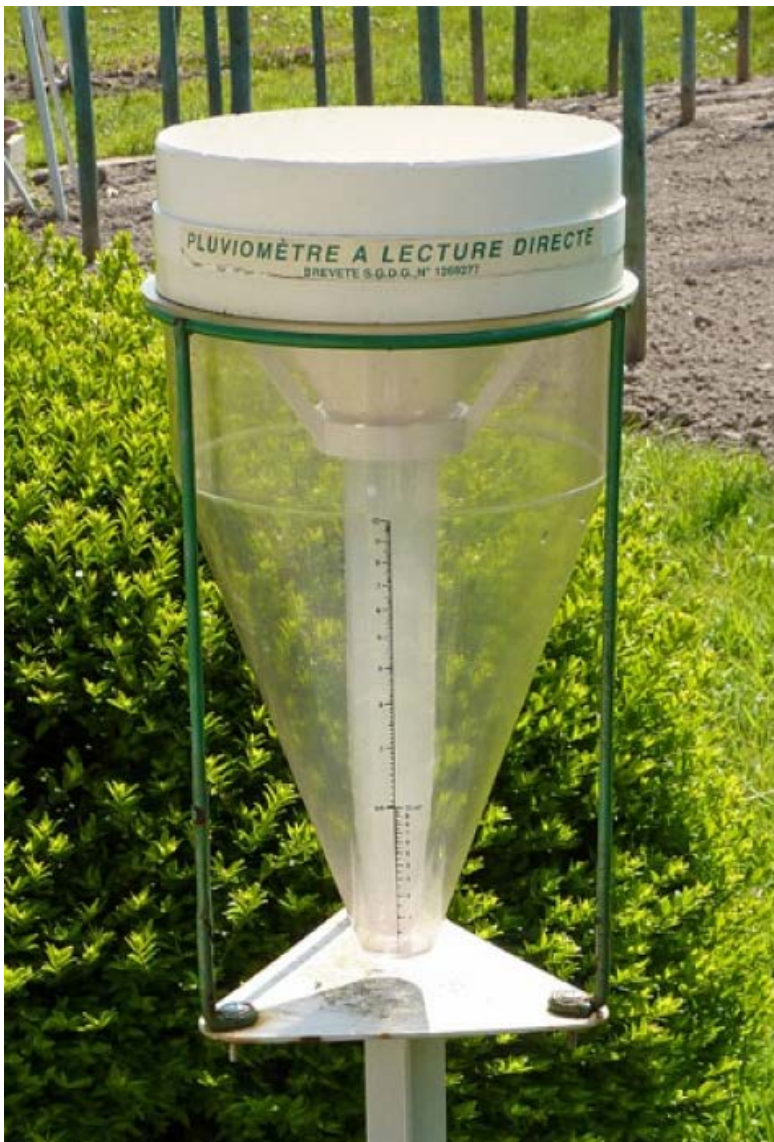
Figure 1 : Photo d'un pluviomètre a lecture directe.
