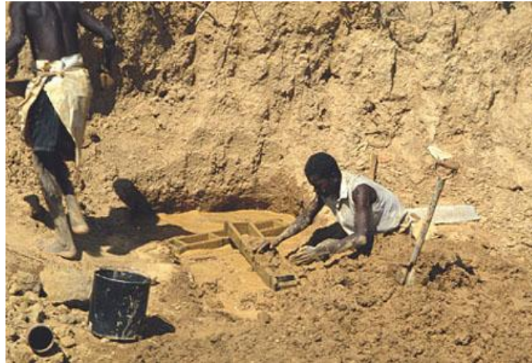
Figura 2: Fabricación de lodo en un molde triple, Zimbabwe. Foto: Practical Action / Theo Schilderman.
